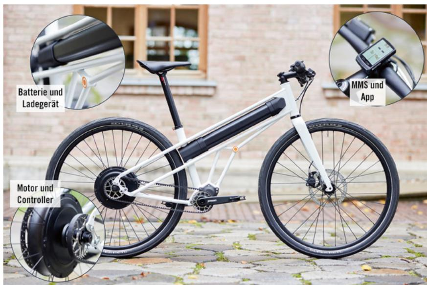
**BILD 4** E-Bike-Antriebssystem (MMS: Mensch-Maschine-Schnittstelle) (© Hirschvogel)
