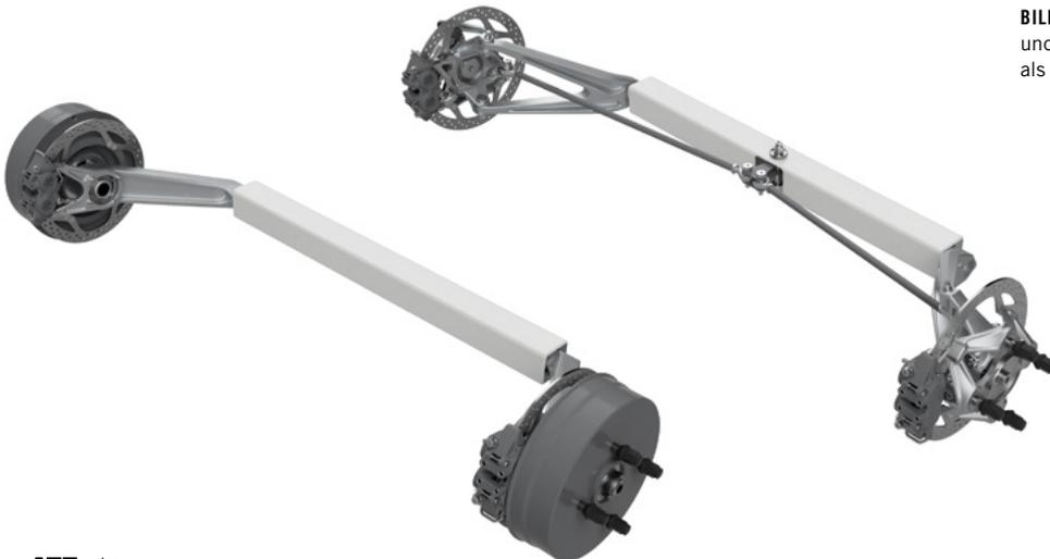
BILD 6 Gefederte Antriebsachse (links) und gefederte, gelenkte Frontachse (rechts) als Computergrafik (© Hirschvogel)
