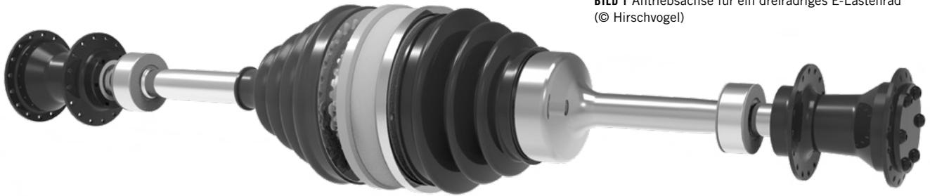
**BILD 1** Antriebsachse für ein dreirädriges E-Lastenrad
